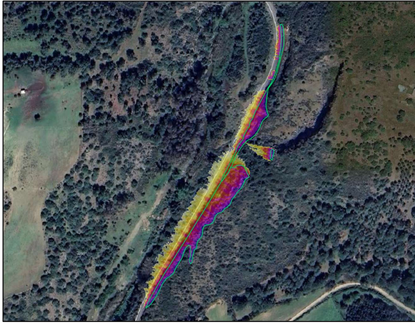
Figura 16: Area della ferrovia con affioramenti (verde) e risultato della simulazione caduta massi (probabilità di raggiungimento).
