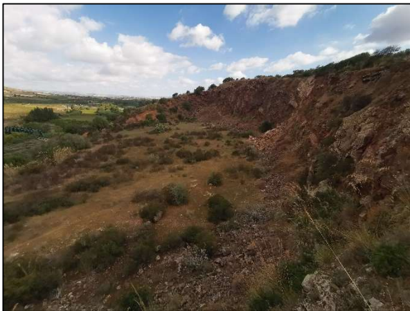
Figura 17: Area di cava abbandonata con pareti sub verticali – verticali.
