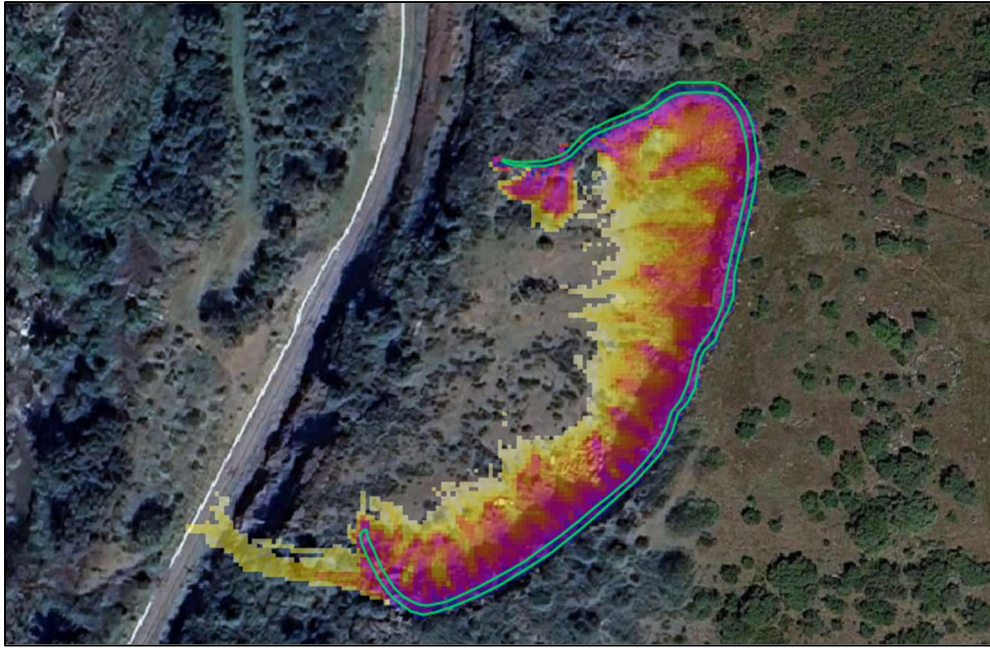
Figura 19: Area di cava con affioramenti (verde) e risultato della simulazione caduta massi (probabilità di raggiungimento).
